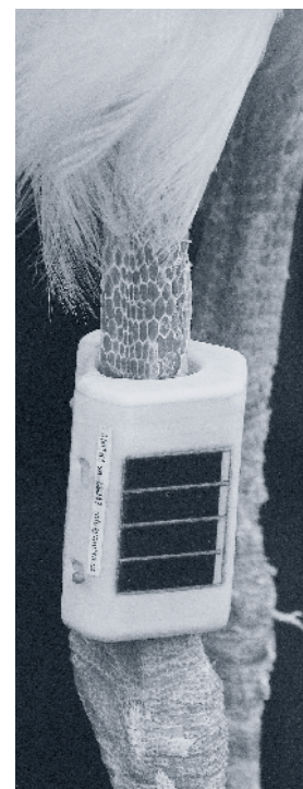
Obr. 2: Detail solárně napájeného GPS-GSM vysíláče ve tvaru ptačího kroužku.
