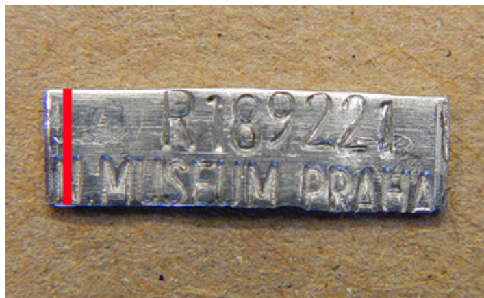
Schéma zastřížení kroužku typu R. Zastřížení provádějte na kroužku sundaném z bužírky, kroužek před zastřížením nenarovnávejte! (Foto: archiv Kroužkovací stanice)
